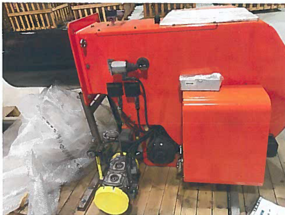
Фото 6 – Очаги коррозии на горелочном устройстве отсутствуют
