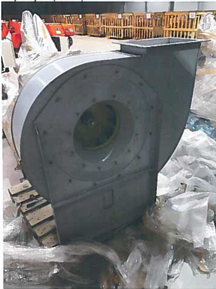
Фото 7 – Вентилятор горелочного устройства
