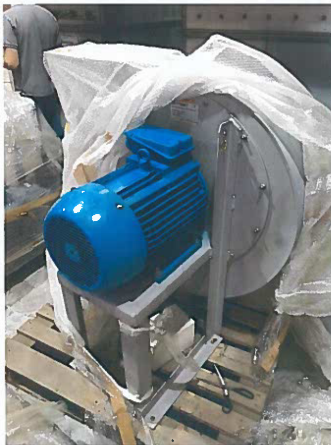
Фото 3 – Вентилятор для горелочного устройства
