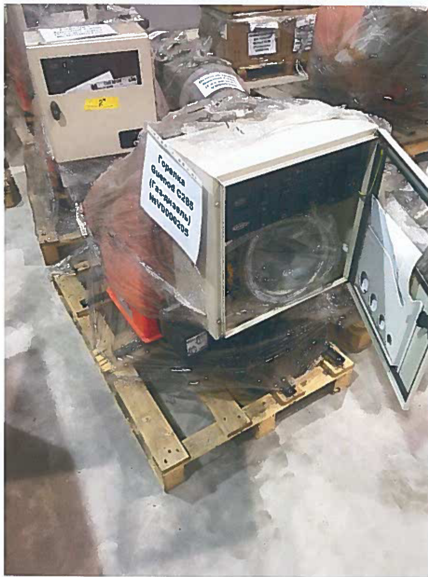
Фото 6 – Встроенный шкаф управления
